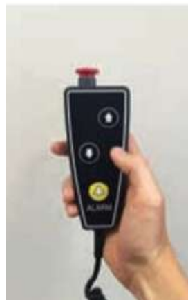
Pulsantiera su cavo.
